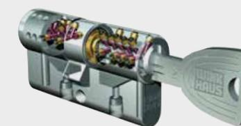
Der **Hochsicherheitszylinder** mit dreidimensionaler, paten-tierter Abtast- und Aufbohr-sicherung sowie Zieh- und Ab-reiß-Sicherung. Die große, spezielle Schlüsselform ermöglicht leichtes Sperren und verhindert Verbiegen und Abbrechen des Schlüssels. Er ist beidseitig sperrbar. Der symmetrische Wendeschlüssel kann sehr leicht in den Zylinder eingeführt werden.
